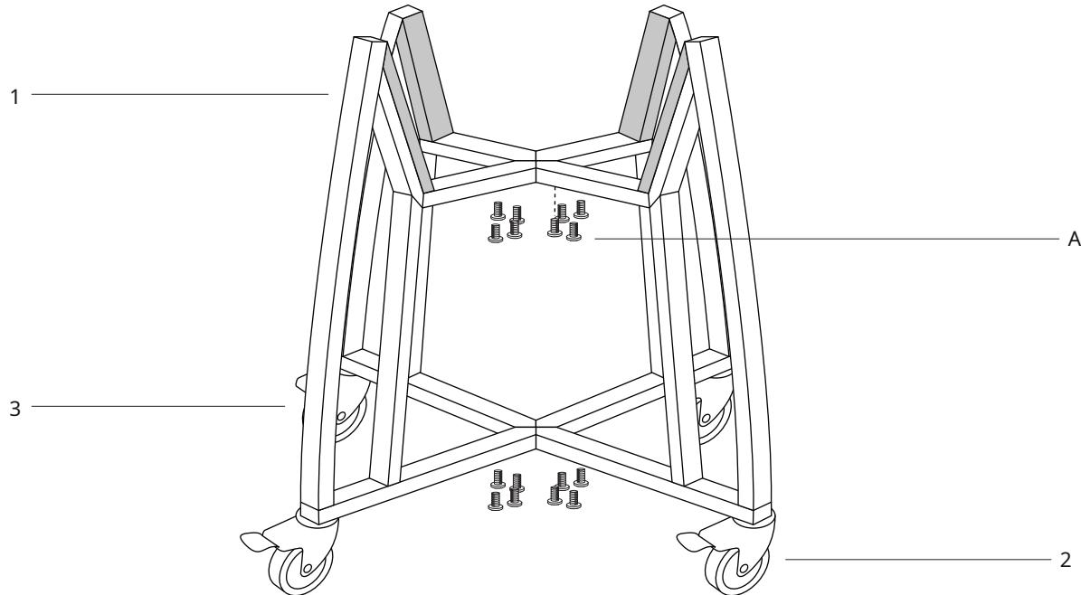
**KORAK 4** -Pričvrstite nosače (1) na poprečne dijelove (4) pomoću 16x vijaka (A). Provjerite jesu li kolica sigurna i svi vijci su zategnuti prije nego što stavite Kamado Grill (9) u njega.
