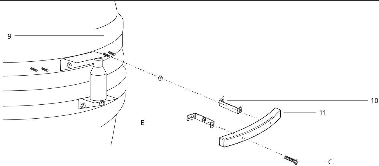
**KORAK 10 -** Za pričvršćivanje ručke (10) na poklopac KamadoGrill-a (9) započnite pričvršćivanjem 2x nosača ručke (11) pomoću 2x vijka (C) i matica (E).
